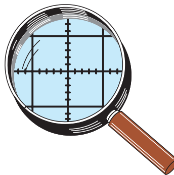
Figure 19: La croix graduée située au centre de l'écran permet d'évaluer les décimales d'une tension. En effet, chaque carreau est verticalement divisé en 5 parties. En fonction du réglage du bouton V/div, chaque partie vaut une tension qu'indique le Tableau 1 ci-après (voir figure 20).
