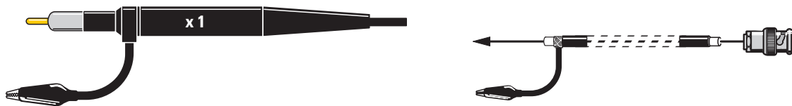
Figure 5: Si votre sonde ne comporte que l'indication x1, le signal acheminé à l'entrée de l'oscilloscope a la même amplitude que celui présent sur la pointe de touche.
