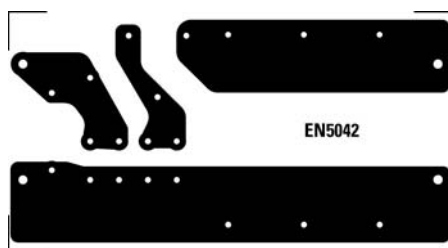
Figure 435b : Dessin, à l'échelle 1, du circuit imprimé de la sonde EN5042.
